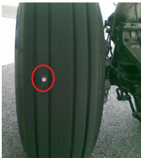
Figura 26 - Danni agli pneumatici causati da F.O.D durante la fase di rullaggio
