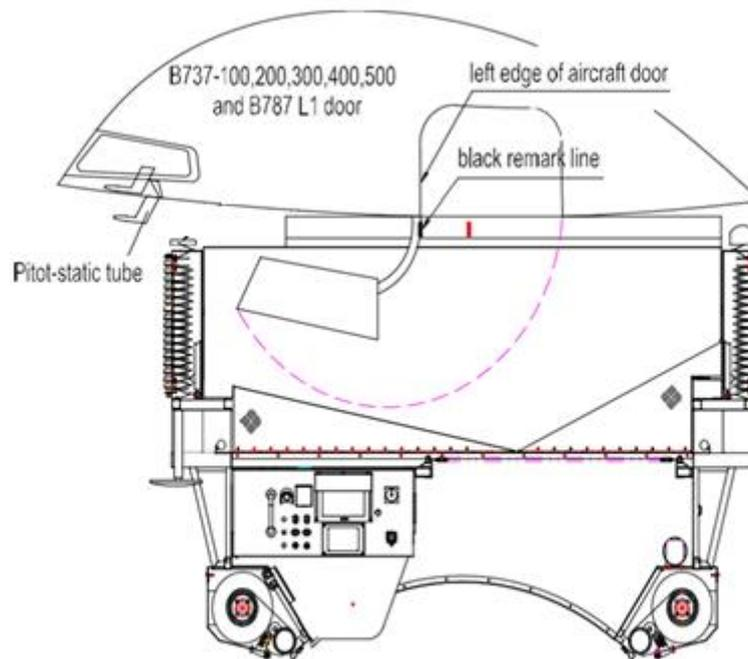
Figure 3-2 Utilizzo della Mark Line nera sul bumper
