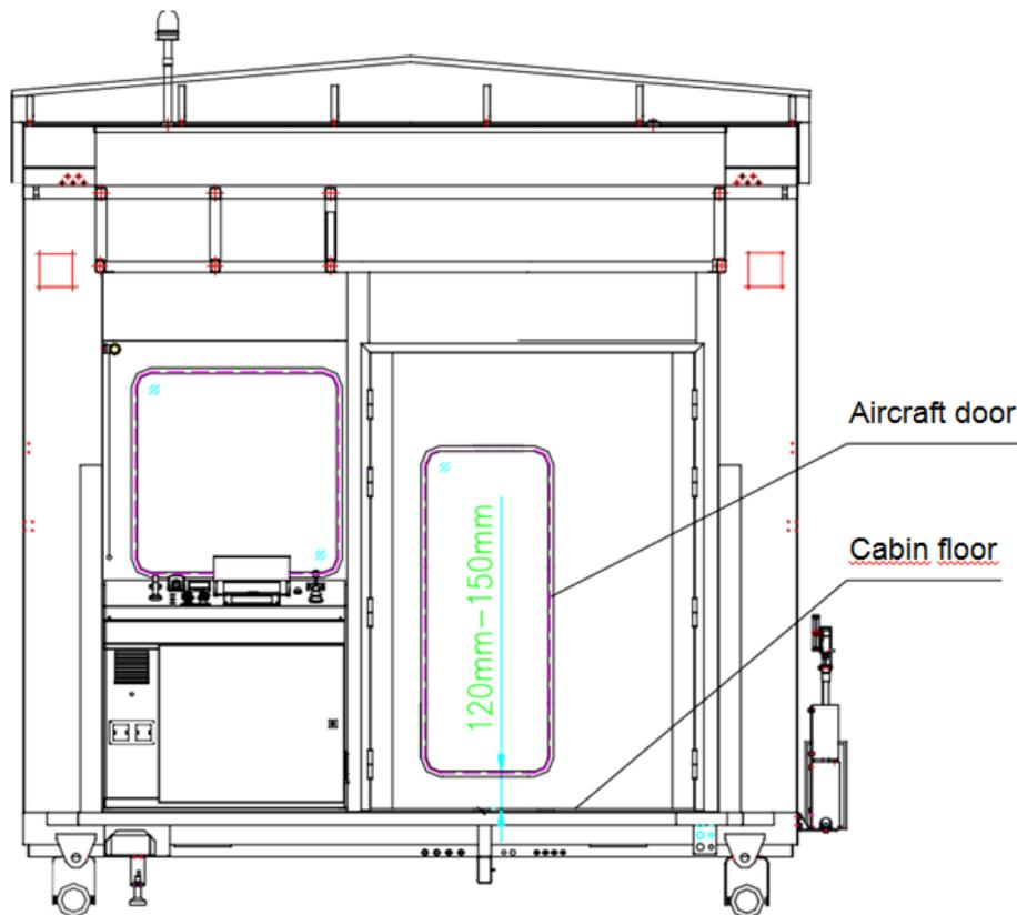
Figure 3-4 Distanza tra pavimento cabina e porta aeromobile
