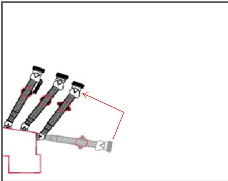
Prima dell'arrivo dell'aeromobile, muovere la PBB C dal punto di parcheggio al punto di parcheggio ausiliario. **Fare attenzione:** prima di effettuare tale operazione portare il pontile in posizione orizzontale
