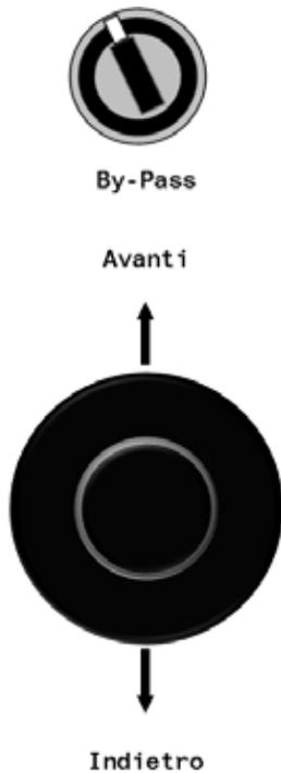
**Il selettore BYPASS può provocare gravi danni sia all'aeromobile che al pontile. Esso può essere utilizzato solo dal personale di manutenzione ed esclusivamente per scopi manutentivi. E' severamente vietato utilizzarlo in altre circostanze.**
