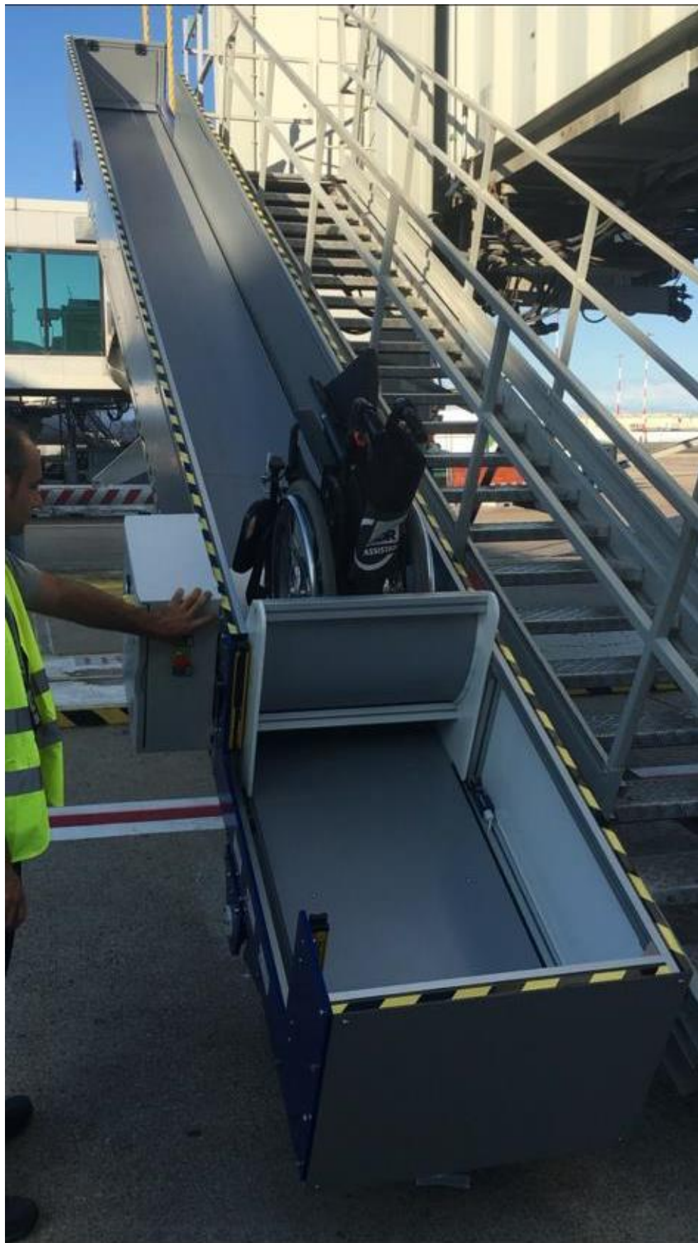
Immagine 7. L'operatore handler aziona il pulsante per la risalita del dispositivo da quota pista a quota pontile
