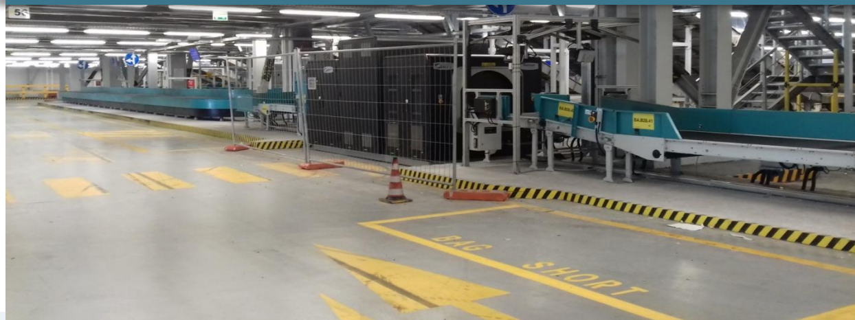
Inserimento 2° Carosello di Back-up con macchina RX BHS/HBS Terminal 1
